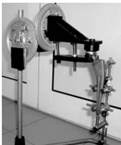
Figure 4. The angular position setting device of the specimen for determination of endurance properties (Dispozitivul de aliniere unghiulară a probelor la încercarea de anduranță)
