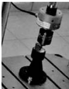
Figure 1. The specimen fixture for endurance properties determination (Sistemul de fixare a probei pentru determinarea proprietăților de duranță)
